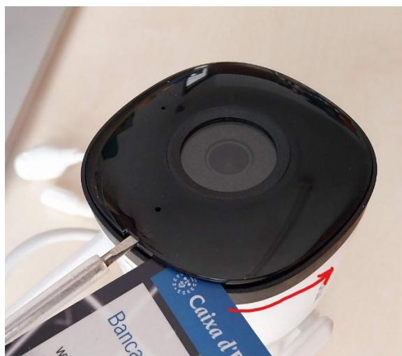
En la foto siguiente se ve la posición de los anclajes, señalados con las flechas rojas y los 4 tornillos que se han de sacar para abrir y acceder al interior de la cámara. Para separar el cabezal negro de la carcasa es necesario extraer primero la tarjeta SD.
